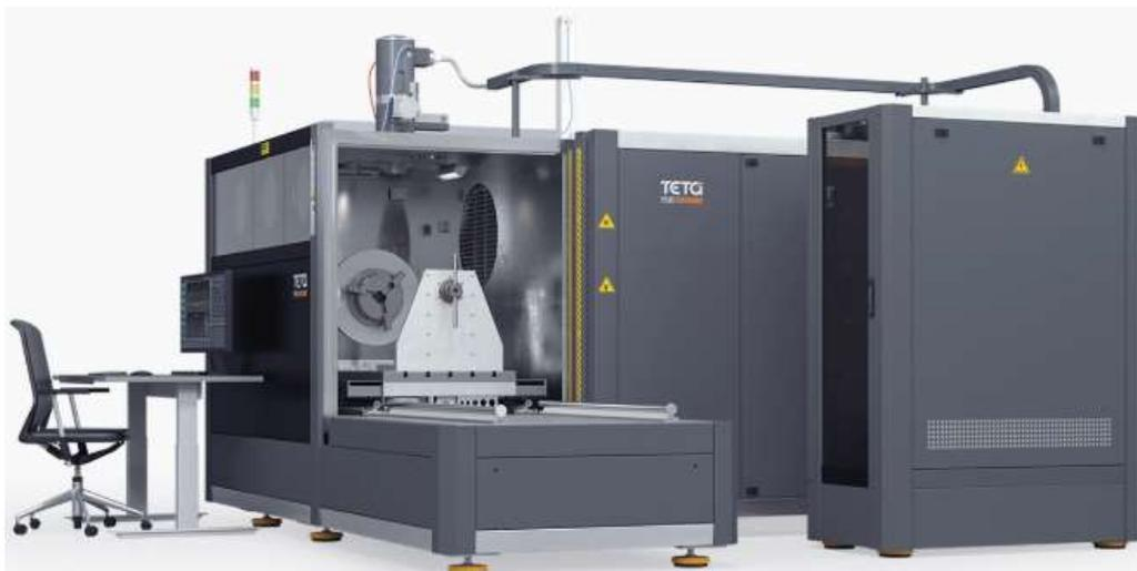
Рис. 1. Пример конструкции установки для электронно-лучевой сварки
