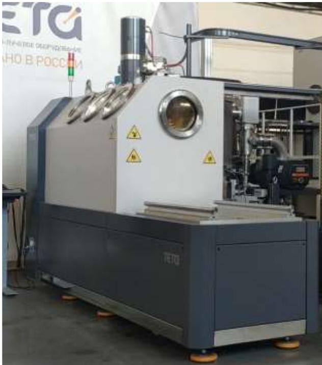
*Рис. 2. Пример конструкции установки электронно-лучевой сварки, оснащенной свинцовыми смотровыми окнами*
