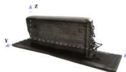
Рис. 1. Образец, полученный по аддитивной технологии ЕВАМ
