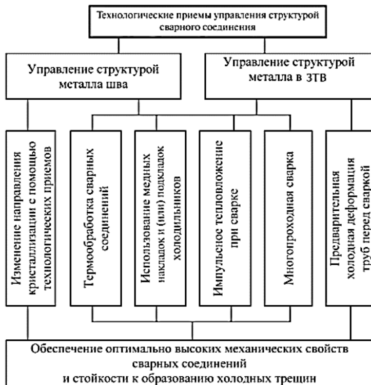
Рис. 1. Технологические приемы воздействия на структуру сварных швов при сварке неплавящимся электродом
