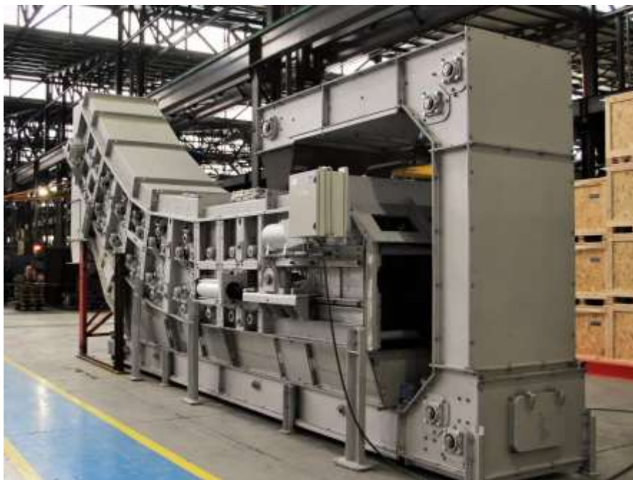
Рис. 2. Подборщик просыпи: конвейер цепной скребковый (MAGALDI)
