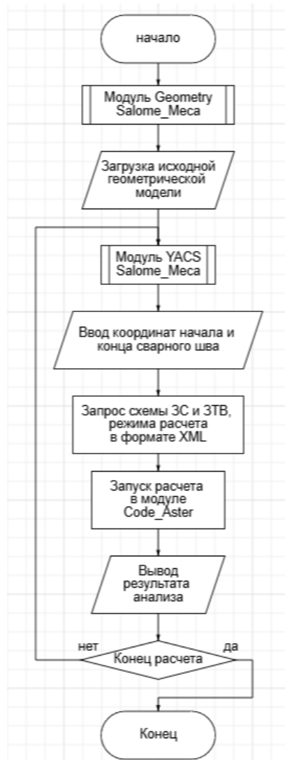
Рис. 8. Алгоритм автоматизации расчета напряженно-деформированного состояния сварных конструкций общего назначения в программной среде Salome_Meca
