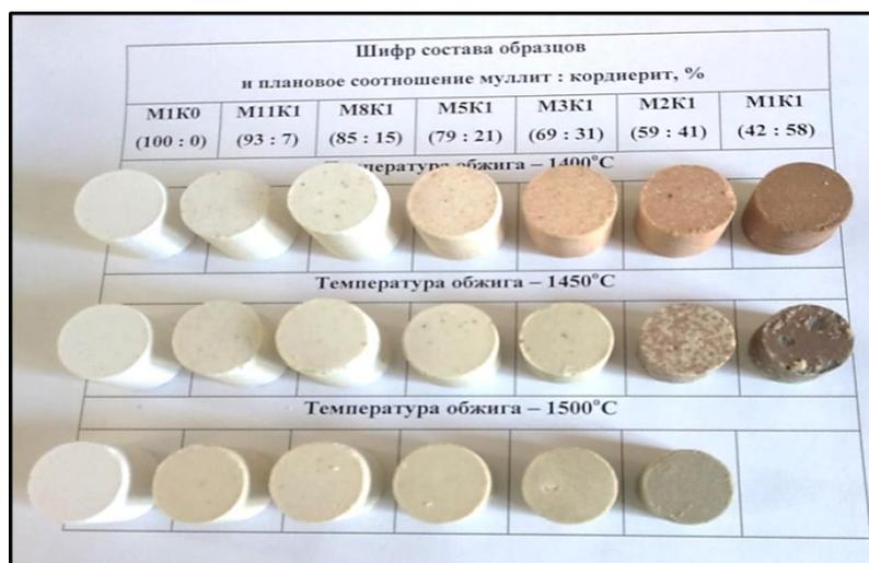
Рисунок 4.3 – Внешний вид обожженных образцов муллит-кордиеритового состава
