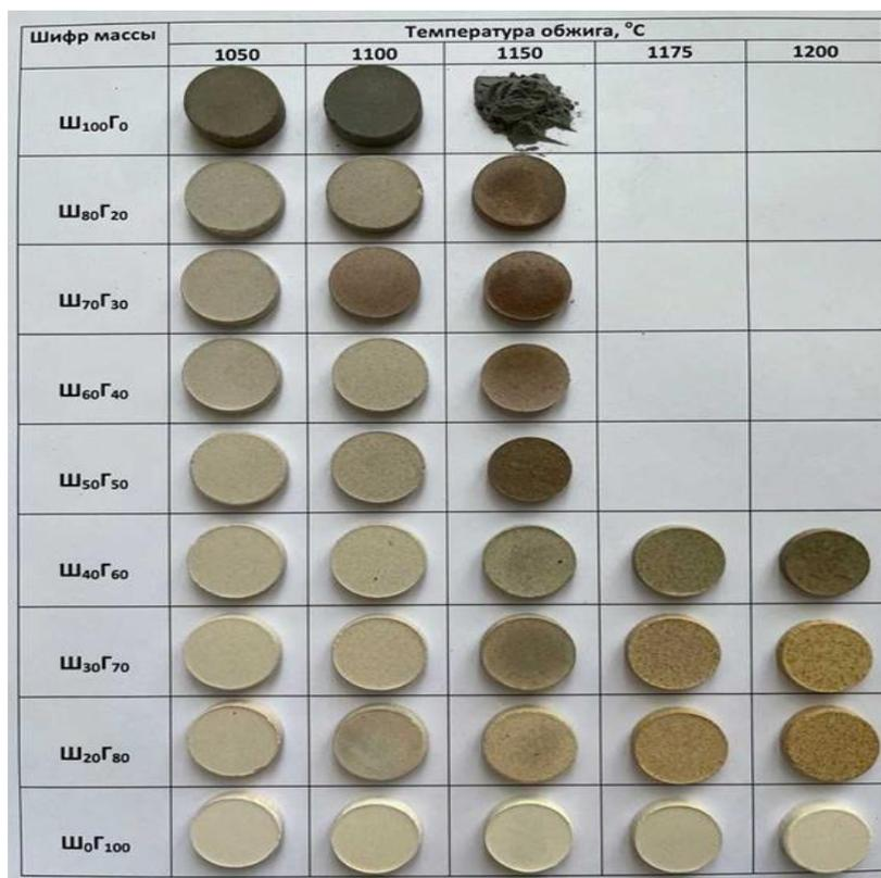
Рисунок 5.3 – Внешний вид обожженных образцов полусухого прессования из смесей металлургического шлака с огнеупорной глиной
