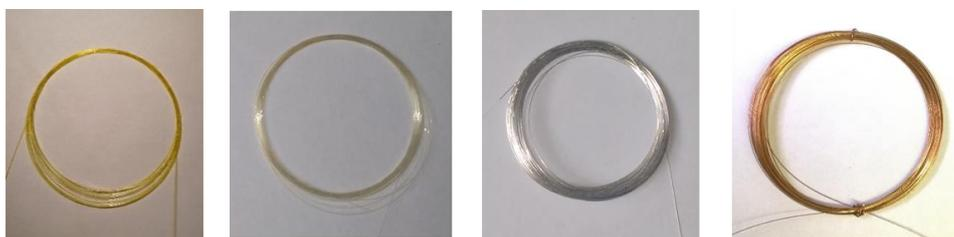
**Рис. 1.** Фотографии ОВ в различных защитных покрытиях из полиимида, акрилата, алюминия и меди (слева направо).
