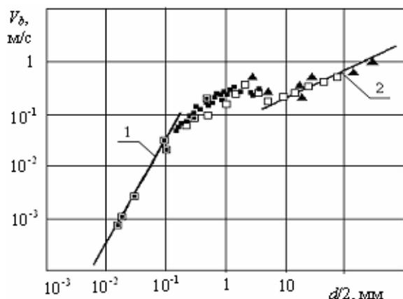
**Рис. 1.** Зависимость скорости пузыря, всплывающего в воде, от его радиуса. Скорость соответствует: 1) закону Стокса  $V_b \sim d^2$ ; 2) уравнению  $V_b \sim d^{1/2}$ . Данные: ■ – Хабермана, Мортон (1956) и Мотарями (1978); ▲□ – С.С. Кутателадзе (1976); ▣ – автора (1986)
