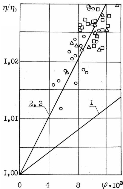
Рис. 3. Зависимость динамической вязкости МГС от объемного газосодержания
