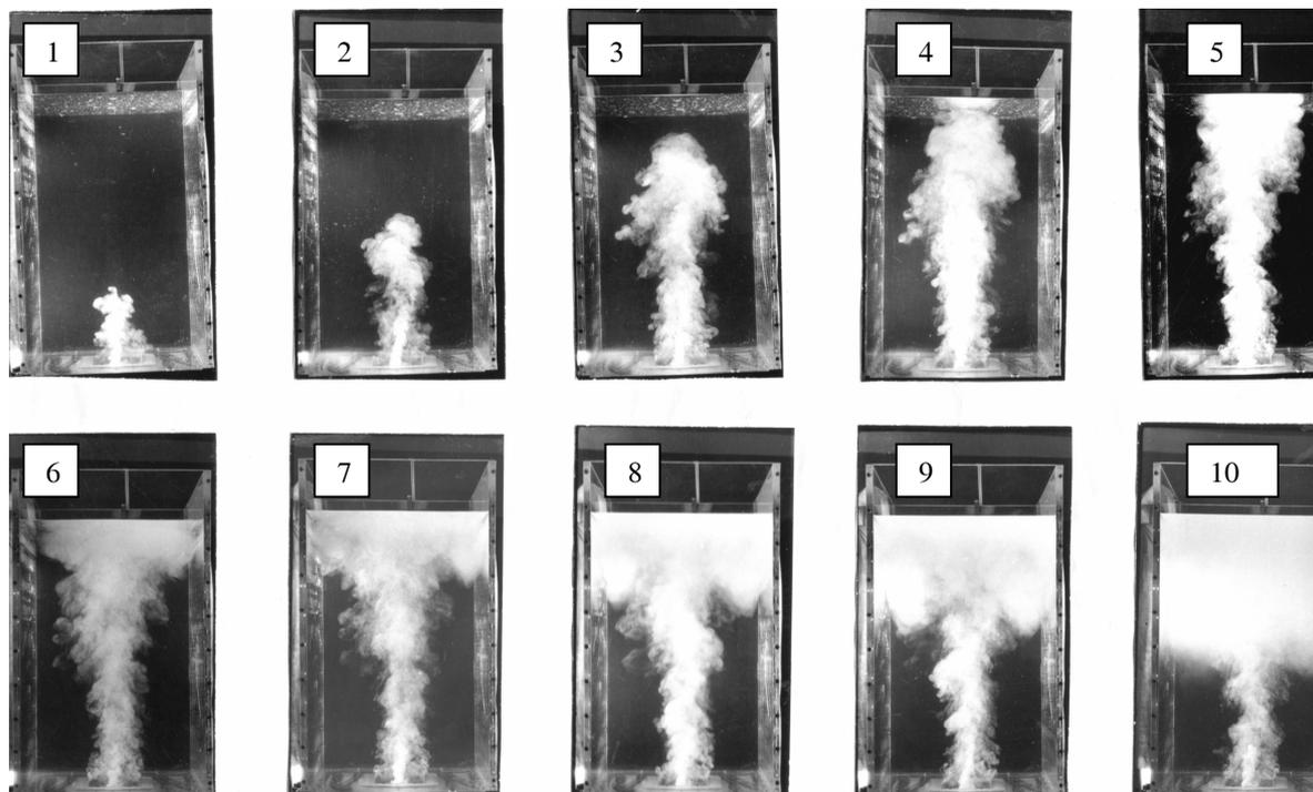
**Рис. 2** Покадровая съемка процесса наполнения бака с водой (размером  $0,7 \times 0,7 \times 1,0$  м<sup>3</sup>) микропузырьками от генератора пузырей, расположенного в центре дна бака
