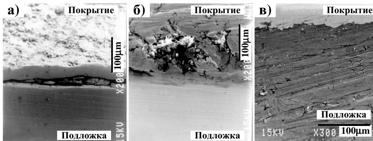
Рис. 3. Микрофотографии шлифов вертикального среза образцов с медным покрытием: а) из стали (Ст.3); б) из нержавеющей стали 12X18H9T; в) из алюминия АД-31
