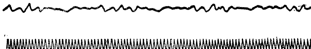
Рис. 3. Виброграмма, снятая с корпуса подшипника скольжения электродвигателя АШЗ-31-6 при динамически уравновешенном роторе. Шкив и вентилятор сняты. Размах колебания 3 мк.
