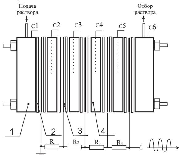
Рис. 6. Ячейка: с1-с6 – секции; R1-R4 – делитель напряжения
